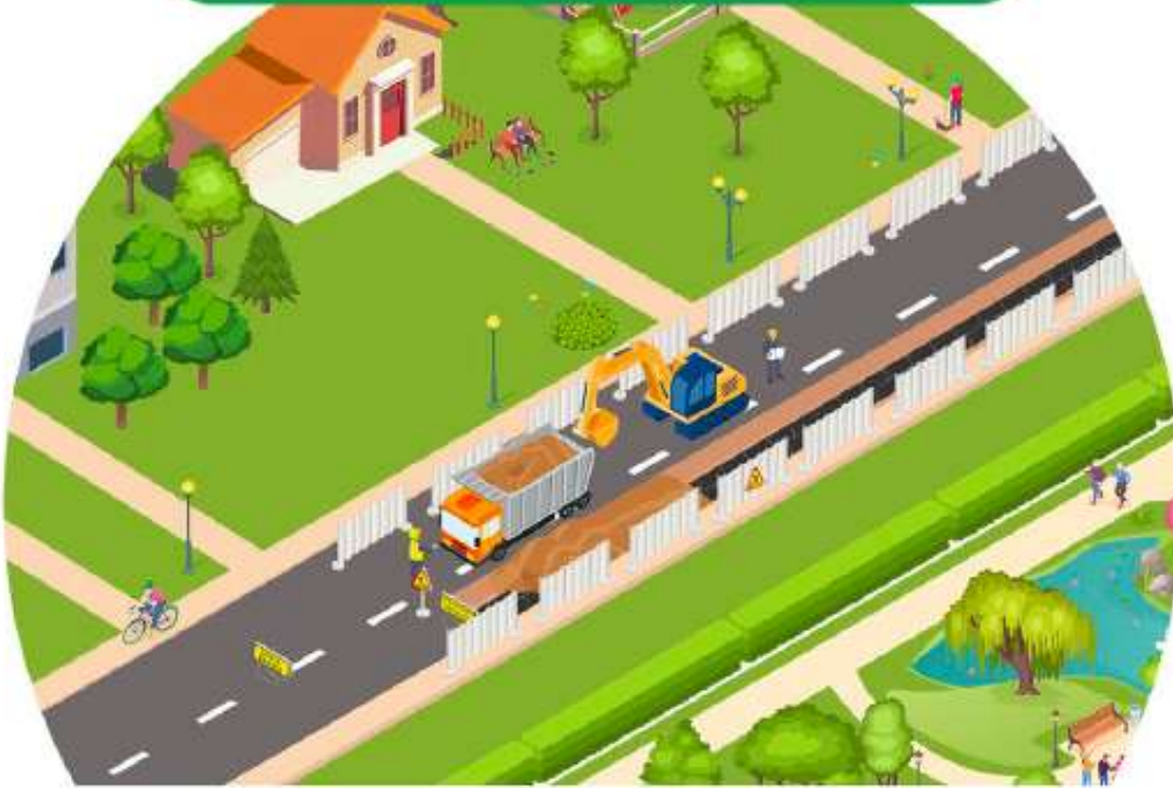
Phase 3 : rebouchage de la tranchée
